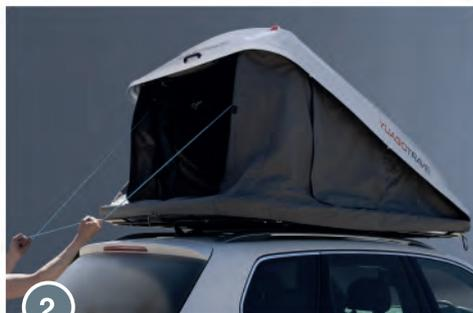
2 Для закрытия крышки автопалатки сильно потяните стропу вниз.
