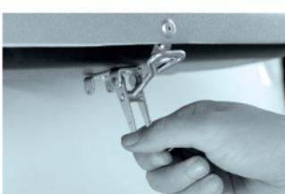
10 Застегните 2 регулируемых натяжных замка в носовой и задней части автобокса.
