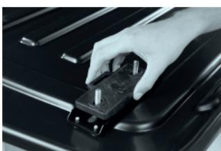
3 Придерживая скобы изнутри автобокса, установите проставки усиителя и наживите гайки «барашек».
