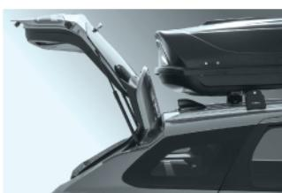
4 Выровняйте автобокс относительно центральной оси автомобиля. Установите бокстак, чтобы открытая дверь багажного отделения не упиралась в него.
