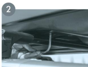
2 Вставьте скобы крепления снизу через поперечины в технологические отверстия днища автобокса.
