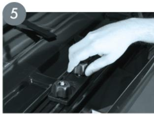
5 Затяните гайки «барашек» усилием пальцев, не используя при этом плоскогубцы или любые другие инструменты\*!!!.
