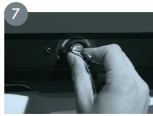
7 Для открытия автобокса вставьте ключ в личинку замка и поверните против часовой стрелки (при открытом автобоксе ключ остаётся в замке).
