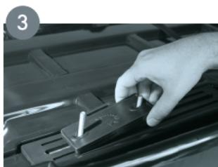
3 Придерживая скобы изнутри автобокса, установите проставки усилителя и наживите гайки «барашек».
