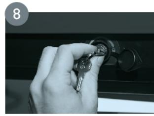
8 Для закрытия автобокса плотно закройте крышку, убедитесь что петли замков заведены в посадочные места механизма запирания, поверните ключ по часовой стрелке.
