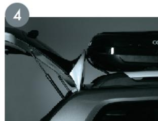
4 Выровняйте автобокс относительно центральной оси автомобиля. Установите автобокс так, чтобы открытая дверь багажного отделения не упиралась в него.
