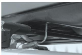
2 Вставьте скобы крепления снизу через поперечины в технологические отверстия дна автобокса.
