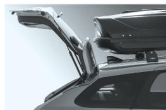
4 Выровняйте автобокс относительно центральной оси автомобиля. Установите автобокс так, чтобы открытая дверь багажного отделения не упиралась в него.
