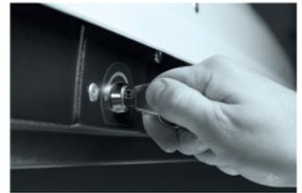
8 Для закрытия автобокса плотно закройте крышку, убедитесь что петли замков заведены в посадочные места механизма запираения, поверните ключ по часовой стрелке. Застегните регулируемый натяжной замок в носовой части автобокса.
