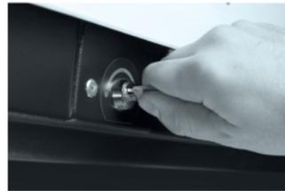
7 Для открытия автобокса, отстегните регулируемый натяжной замок в носовой части автобокса. Вставьте ключ в личинку замка и поверните против часовой стрелки (при открытом автобоксе ключ остаётся в замке).
